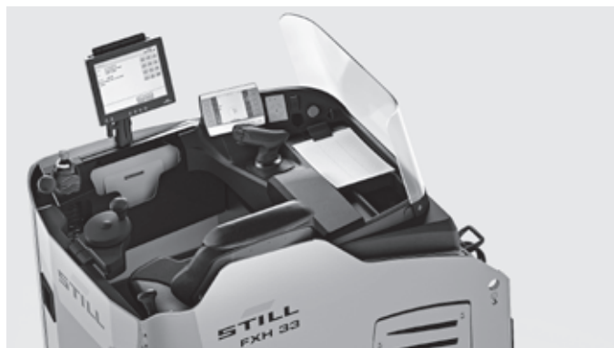
Facilità di posizionamento di un terminale dati (opzionale) e di altri accessori grazie alle guide porta accessori integrate
