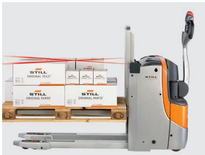
La funzione di sollevamento automatico offre un'ergonomia ideale sollevando o abbassando automaticamente le forche
