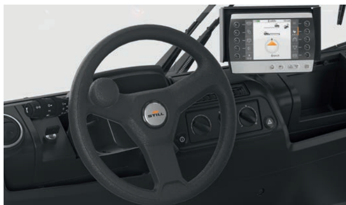
Il volante scorrevole con pomello assicura la massima ergonomia. L'ampio display offre all'operatore una panoramica completa delle informazioni disponibili
