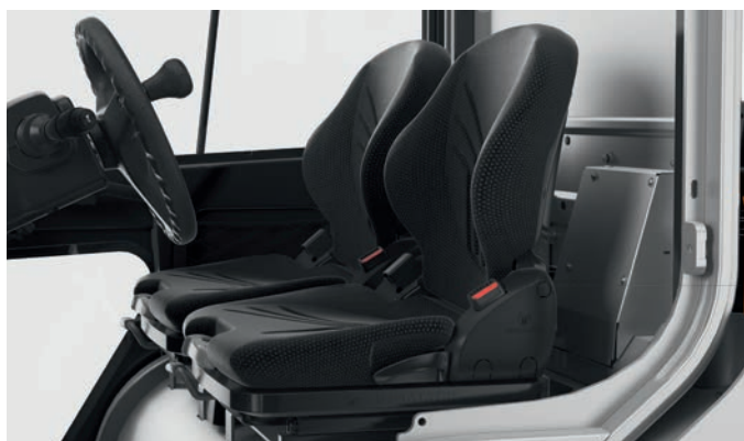
Comfort di lavoro unico nel suo genere, con sedile a sospensione pneumatica MSG 75 opzionale: sospensione eccellente su telaio ammortizzato e molleggiato
