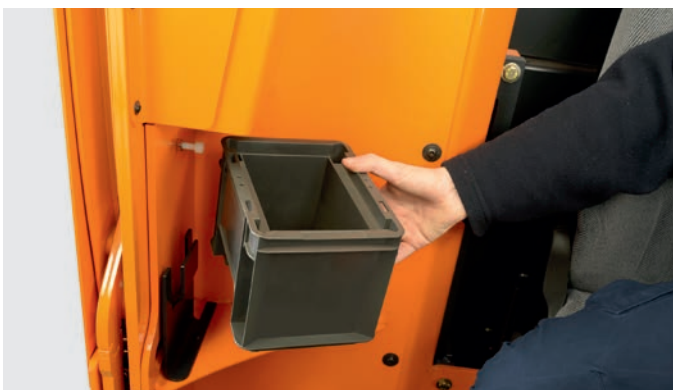
Diverse opzioni di fissaggio per una configurazione personalizzata della postazione di guida
